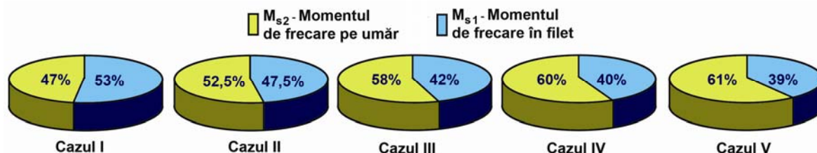
Fig. 3. Ponderele momentelor de frecare în filet și pe umăr, pentru diverse situații de contact.
