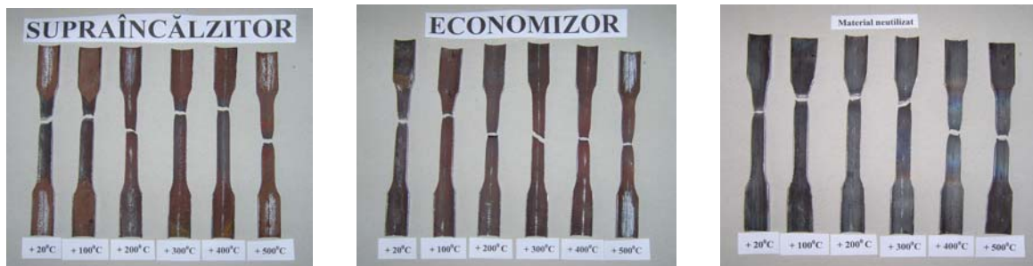
Fig. 5. Loturi de epruvete încercate, din elementele analizate
