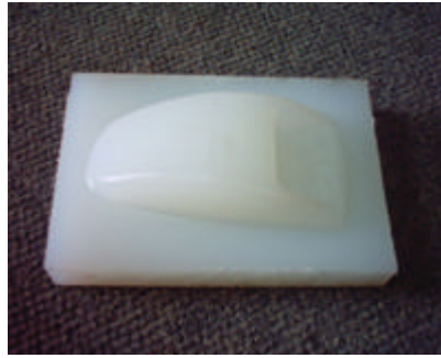
Figura 4. Semimatră fabricată pe centrul de prelucrare cu CNC
