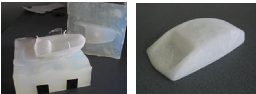
Figura 2. Matrită din cauciuc siliconic și piesa turnată [1].
