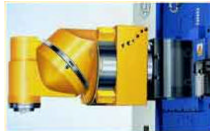
Fig. 2. Cap de frezat cu pozitionare pe axa A: a – model; b – constructie.
