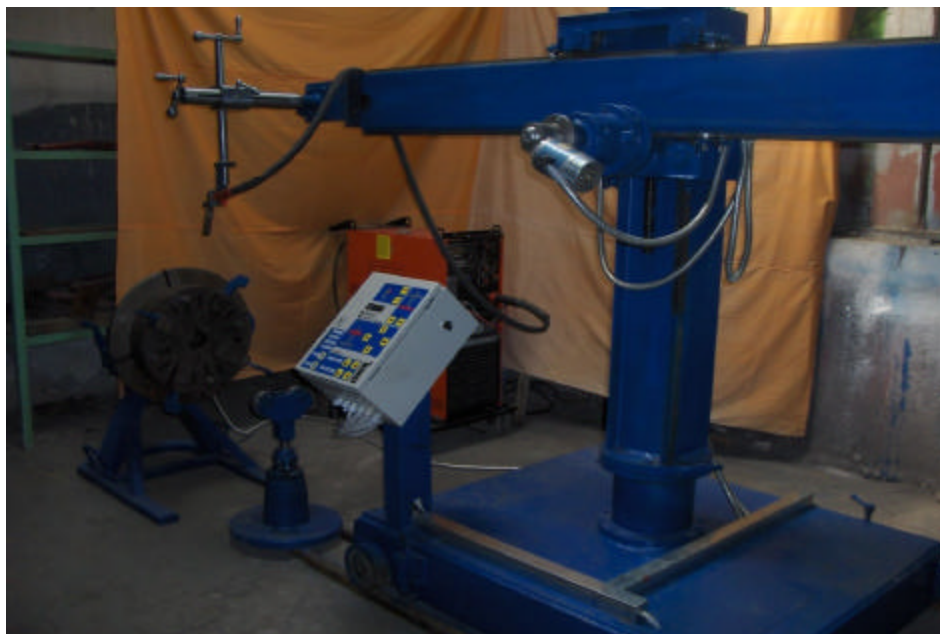
Fig.3 Sistemul tehnologic de reconditionare-sudare
