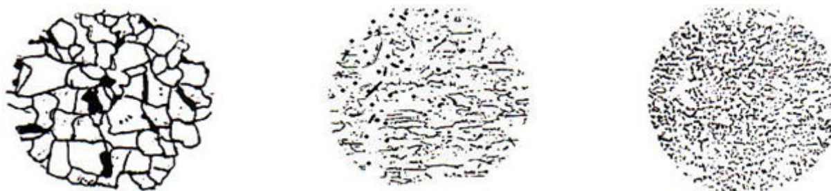
Fig. 4. Structura otelurilor bifazice dupa recoacere în domeniile \alpha (a), \alpha (b), \alpha + \gamma (c)
