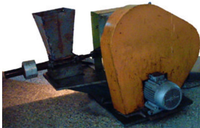
Fig. 3. Instalatia experimentală de brichetat puzderii de cânepa, fotografie.
