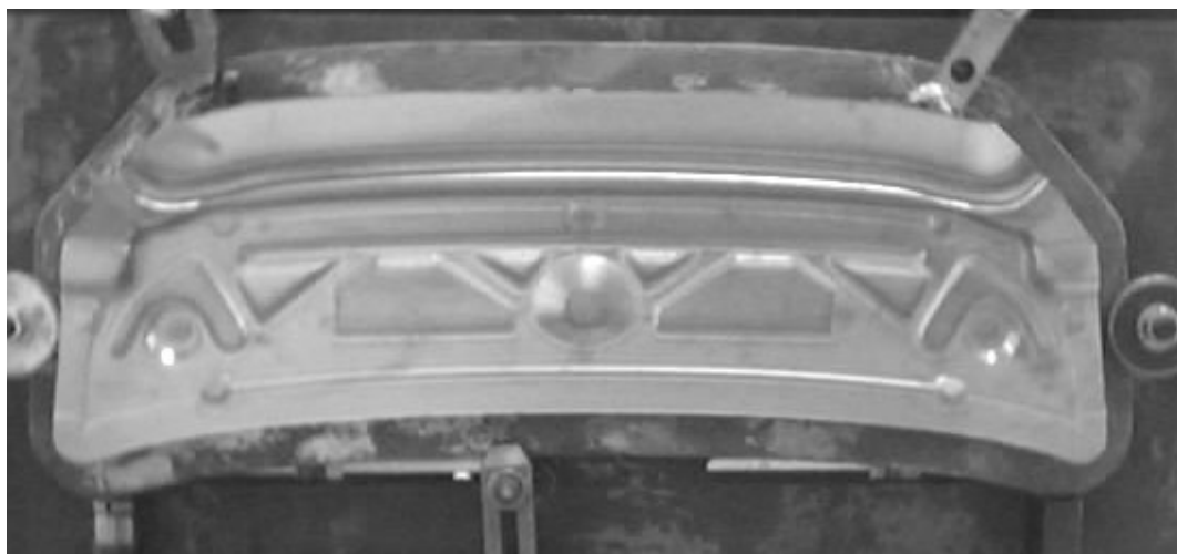
Fig. 4. Poanson prelucrat după tehnologia șablon
