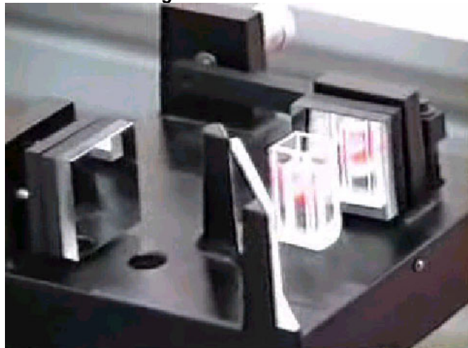
Figura 4. Cuva cu proba de analizat amplasată în interferometrul Michelson
