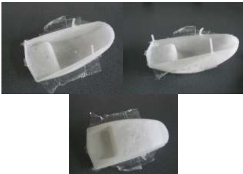
Fig.7. Piesa turnată după extragerea din matriță, unde pot fi observate tije din plastic formate în găurile de aerisire. [7]
