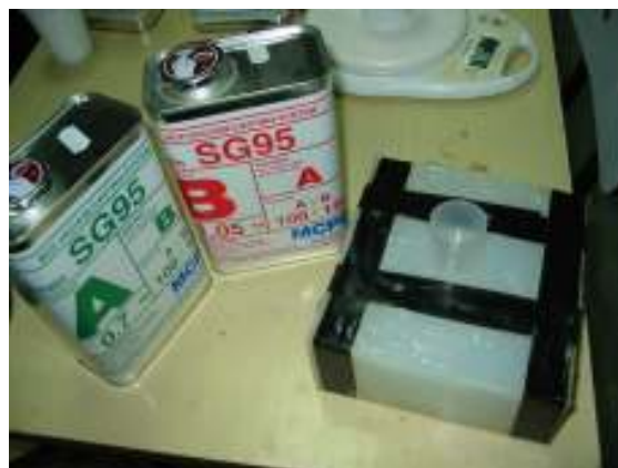
Fig. 5. Componentii A și B ai rășinii SG 95 utilizați la turnarea piesei [7]
