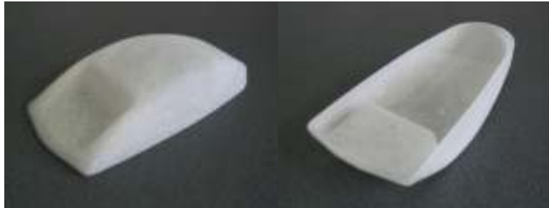
Fig. 8. Piesa obținută prin turnare sub vid în matrița din caucic siliconic [7]
