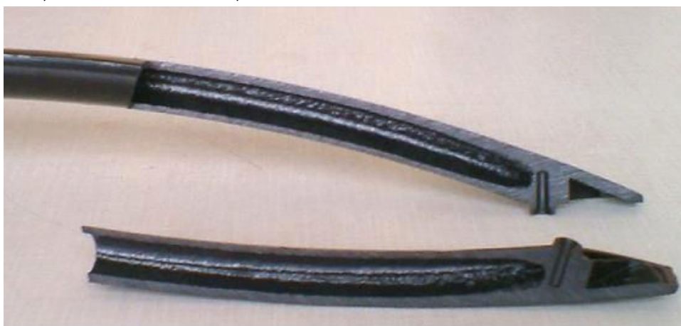
Fig. 4 Piesa injectată folosind procedeul GIT
