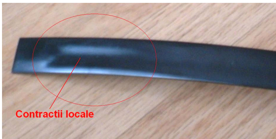
Fig. 3 Contractii locale pe piesa injectată prin procedeul clasic
