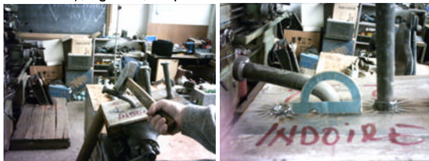
Figura 8. Incercarea tehnologica de rupere prin îndoire
