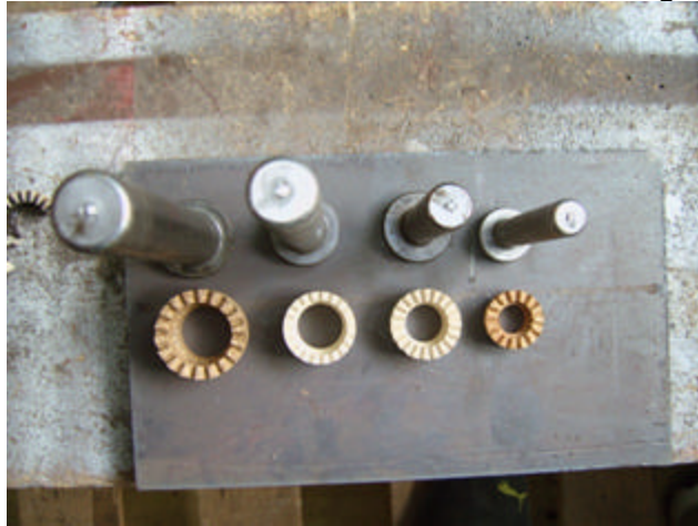
Figura 2. Geometria bolturilor si a inelelor ceramice
