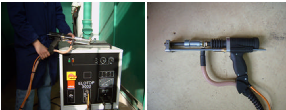
Figura 4. Instalatia de sudare bolturi tip ELOTOP 3002 (Pistoletul K24)
