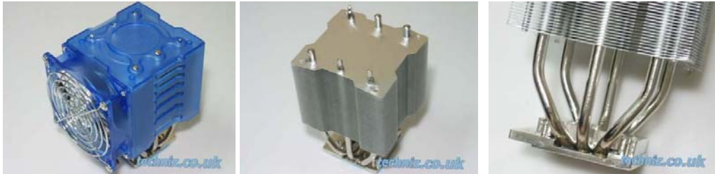
Fig. 2 L'utilisation de « heat pipe » sur le CPU
