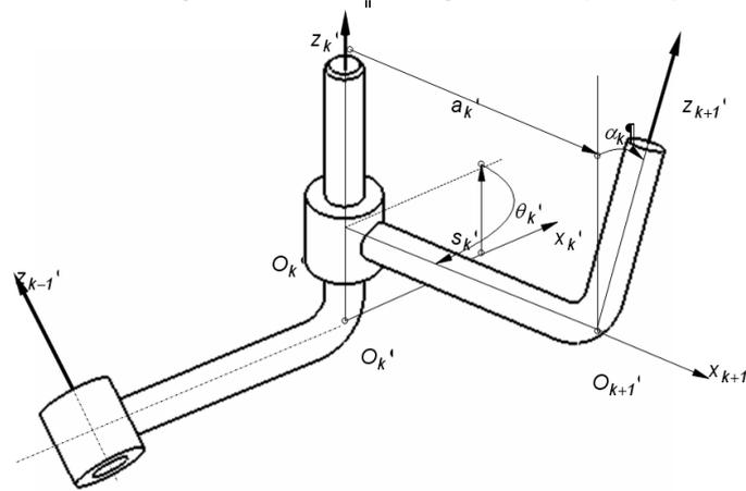
**Fig. 2. Hartenberg-Denavit parameters**
