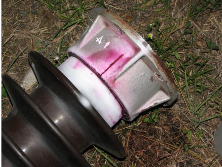
Fig.4.4. Longitudinal fissure in the metallic cup.
