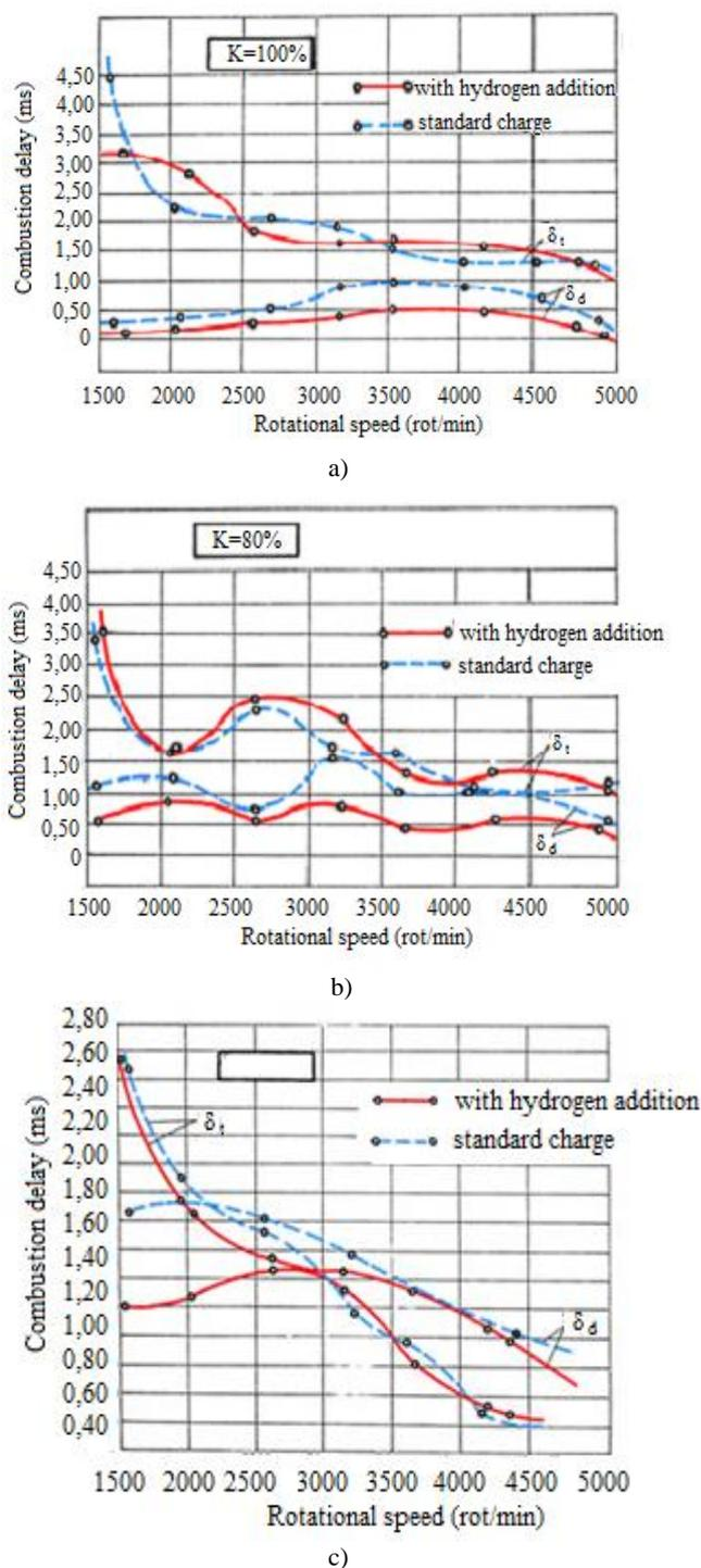
Fig.2. The combustion delay for: a)  $K=100\%$ ; b)  $K=80\%$ ; c)  $K=40\%$
