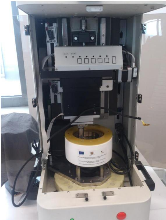
Fig. 7. The tribometer
