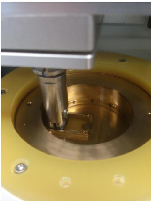
Fig. 8. The pin on disk module
