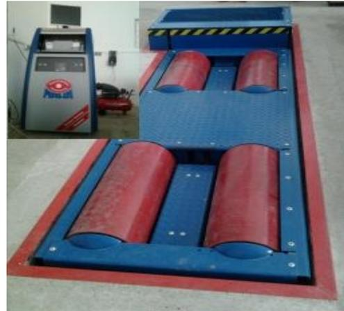
Fig. 2. The *LPS 3000 MAHA* chassis dynamometer
