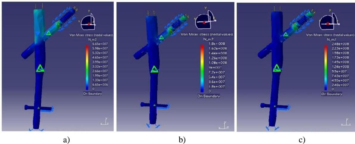
**Figure 5.** Ti-6Al-7Nb test at: a) 1500 N; b) 2000 N; c) 2500N
